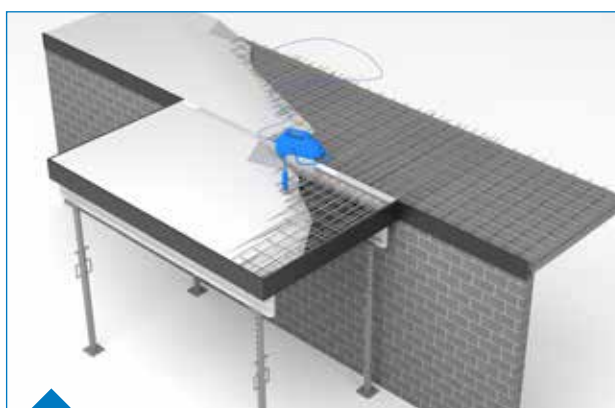
5 Beton goed trillen t.h.v. ISOFOR® - Bien vibrer le béton près de l'ISOFOR®
