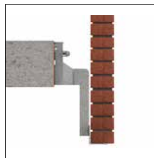
Avec latte soudée à l'arrière de la cornière
