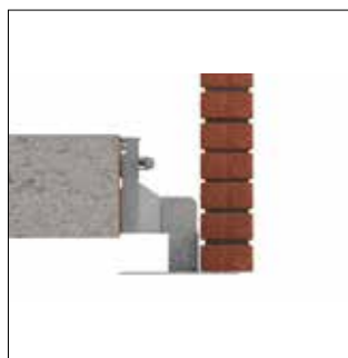
Profil en T pour fermer la coulisse
