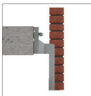
Support avec batée pour screens ou volets roulants
