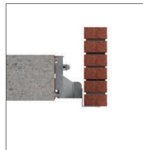
Consoles avec réglage 3D
