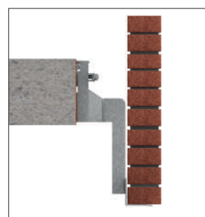
Avec plat de batée derrière la cornière
